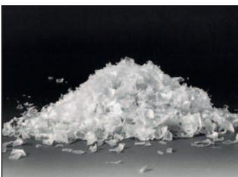
In der weiteren Verarbeitung werden PET-Flocken (PET-Flakes) gewonnen. Diese haben eine hohe Qualität. Deshalb werden sie für die Produktion von neuen Flaschen eingesetzt.
