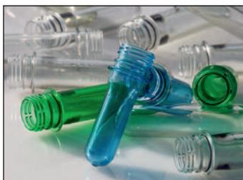
Aus den PET-Flocken wird im ersten Schritt ein Vorformling (Preform) erstellt. Dieser Vor-formling hat bereits den end-gültigen Flaschenhals und das Deckelgewinde.
