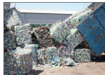
Die gesammelten PET-Flaschen werden mit der Bahn oder mit dem Lastwagen in eines der fünf Sortierzentren geliefert. Die PET-Flaschen werden zu 250 kg schweren Ballen gepresst.
