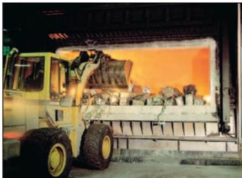
Die Recyclingwerke schmelzen Aluminiumschrott wieder ein. Wird Aluminium recycelt, können 95 % der Herstellungsenergie gespart werden.
