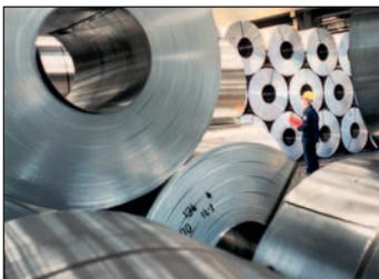
Vormaterial von Aluminiumdosen sind Aluminiumbänder. Aus den Aluminiumbändern werden Näpfe gestanzt und Dosenkörper geformt.
