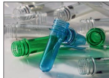
Aus den PET-Flocken wird im ersten Schritt ein Vorformling (Preform) erstellt. Dieser Vorformling hat bereits den endgültigen Flaschenhals und das Deckelgewinde.
