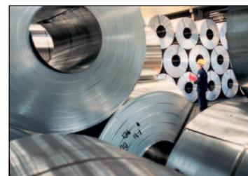
Vormaterial von Aluminiumdosen sind Aluminiumbänder. Aus den Aluminiumbändern werden Näpfe gestanzt und Dosenkörper geformt.
