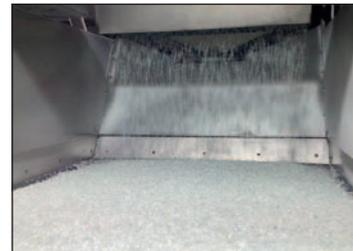
Die sortierten PET-Flaschen werden zerkleinert. Anschlies-send werden die Deckel und die Etiketten vom PET getrennt. Das PET wird in einem mehrstufigen Recyclingprozess aufbereitet.
