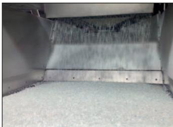
Die sortierten PET-Flaschen werden zerkleinert. Anschliessend werden die Deckel und die Etiketten vom PET getrennt. Das PET wird in einem mehrstufigen Recyclingprozess aufbereitet.
