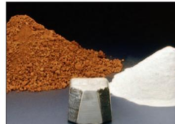
Aus Bauxiterz wird in drei Schritten reines Aluminium gewonnen. Ein Zwischenprodukt ist die Tonerde.
