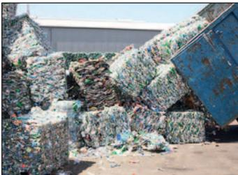
Die gesammelten PET-Flaschen werden mit der Bahn oder mit dem Lastwagen in eines der fünf Sortierzentren geliefert. Die PET-Flaschen werden zu 250 kg schweren Ballen gepresst.
