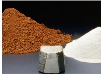
Aus Bauxiterz wird in drei Schritten reines Aluminium gewonnen. Ein Zwischenprodukt ist die Tonerde.
